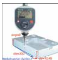
Bestimmung und Korrektur der Werkzeugausrichtung
